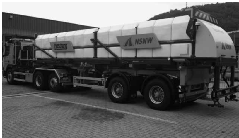
Zur weiteren Optimierung der präventiven Einsätze wurden im 2013 drei FullWet-Systeme mit je 21000l Solevolumen angeschafft.
