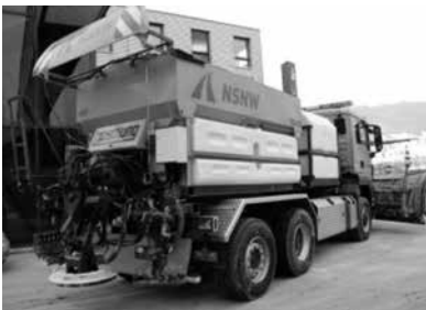
Zur Optimierung des Winterdienstes setzt die NSNW seit mehreren Jahren Kombistreuer ein. Das Sprühen von Sole dient dem präventiven Einsatz.
