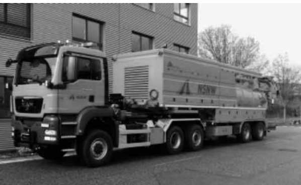
Ein Saug- und Spülfahrzeug ist eine innovative Weiterentwicklung des konsequenten Aufliegerkonzeptes der NSNW.
